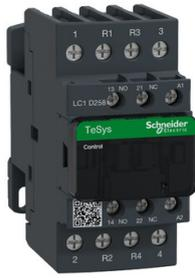
contacteur TeSys LC1-D - 4P (2F + 2O) - AC-1 440V 40 A - bobine 400 V CA
